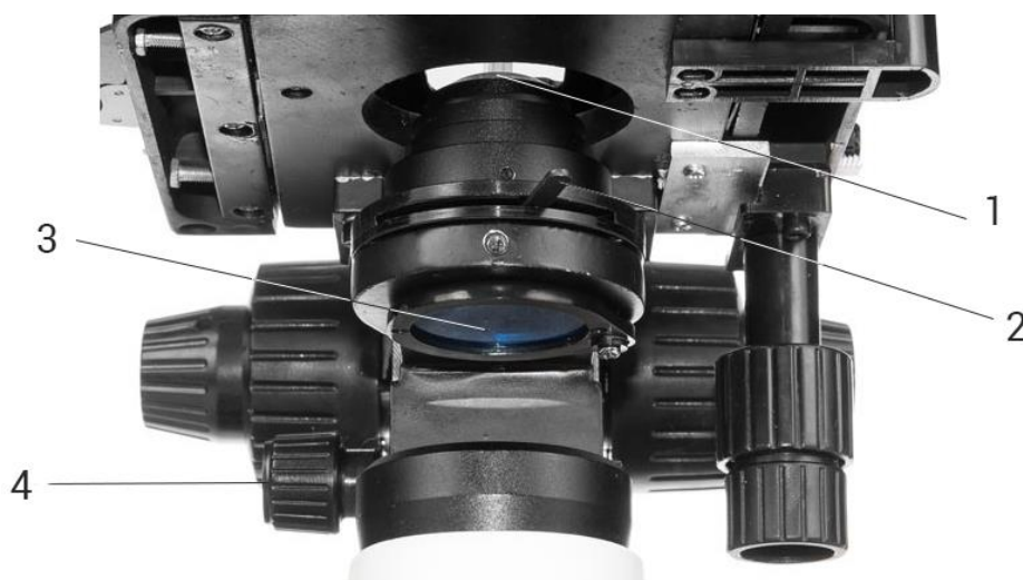
Мал. 2. Конденсор та елементи його налаштування
